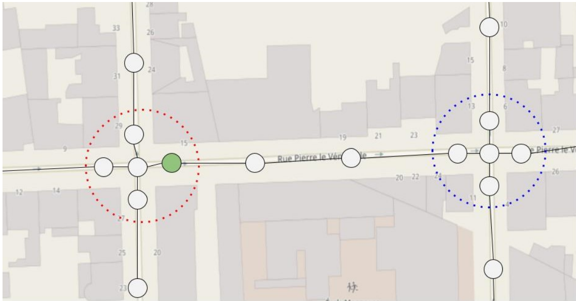
FIGURE 9 – Exemple de configuration du graphe OSM G
